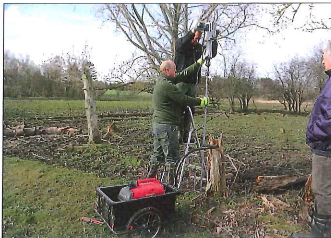
Figur 4. Undersøgelse af vandforholdene i Vasby Mose ved presse vandstandsør med filter ned i jorden med en "brolægger".
