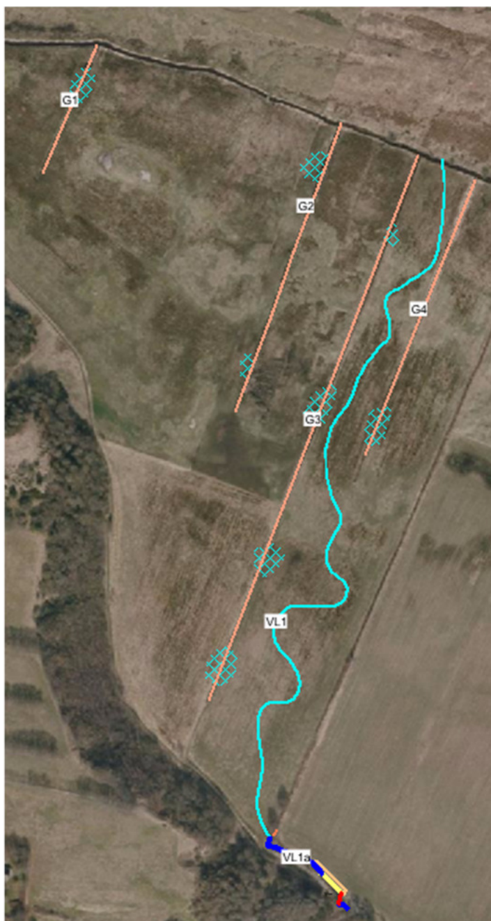
Figur 3 Omlægning af afløb fra Hjuldal og sløjfning af grøfter i vest. Skravering viser mulige skrab
