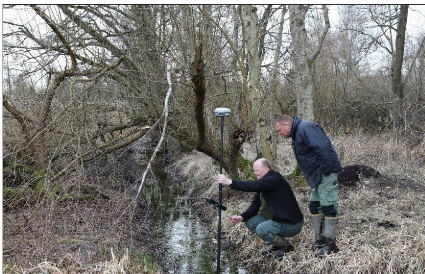
Figur 4: Nøjagtig opmåling af vandløbsbund med differential GPS udstyr.
