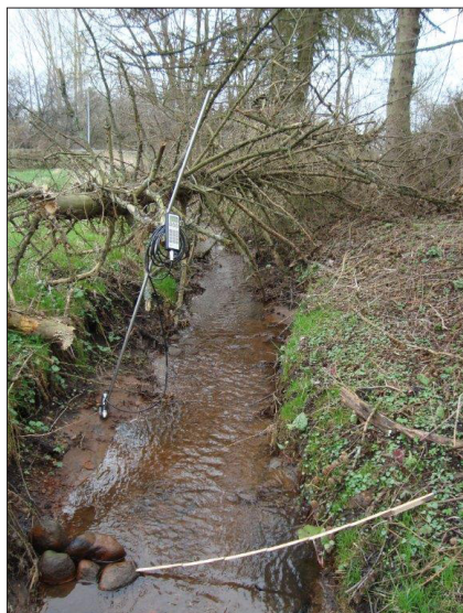
Figur 6: Måling af vandføring i ær og grøfter med elektromagnetisk flowmåler
