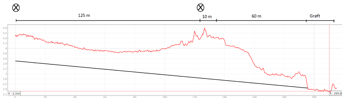
Figur 3-6 Terrænprofil af området, hvor der ønskes en omlægning af dræn. Terrænkoten for den nord-sydgående grøft er angivet længst mod højre på figuren.
