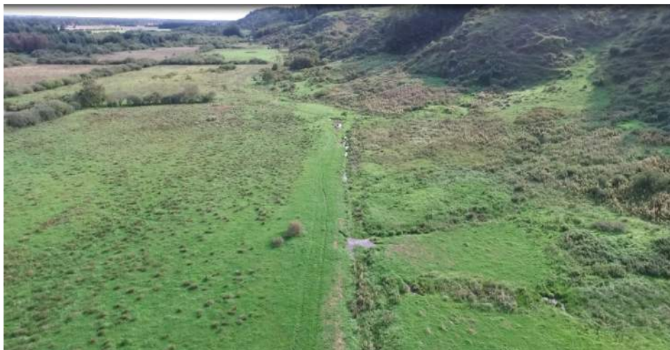
Figur 11 Dronefoto viser at vandet fra kildevældene mod syd (til højre i billedet) samles i en grøft og ledes mod vest via grøfter til Svenstrup Å. Den forhøjede balke med hjulsporet midt i billedet gennembyrdes, grøften opfyldes, og kildevandet kan frit overrisle/sive gennem engen mod nord (til venstre).
