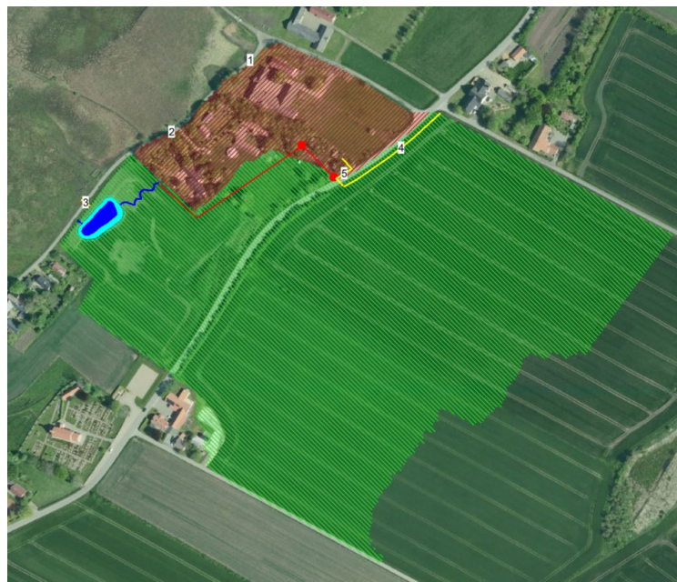
Figur 21 Afvanding med projekt (rød=2,1 ha, grøn=13,2 ha). Afløb nr. 5 erstattes af det nye vandløb.
