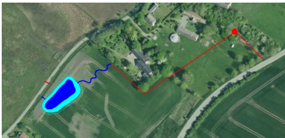
Figur 15 Tiltag i syd. Søens bund er vist med blå og lyseblå flade viser søens vanddækkede skråninger. Den stiplede linje viser overkant af udgravningen.
