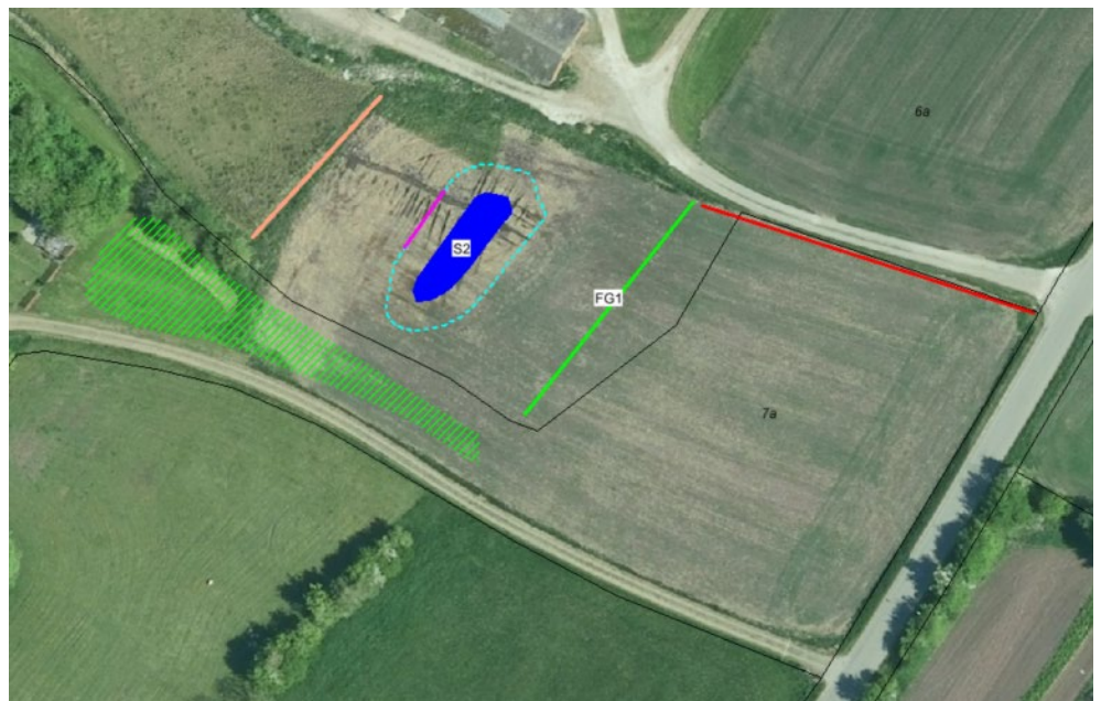
Figur 8 Vesløs midt - ny sø, overrisling m.v. ved Gammel Feggesundvej 26. Blå er søens bund mens stiplede lyseblå strege viser maksimal udbredelse. Lilla strege viser overløbskant. Grøn=fordelergrøft og brun=grøft, der tilkastes. Skraveret grøn=terrænregulering. Rød er nyt rør.
