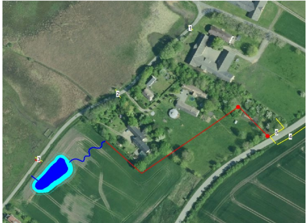
Figur 18 Vejafvanding. Rør nr. 5 fjernes og erstattes af et nyt. Der etableres ekstra rør ved nr. 3
