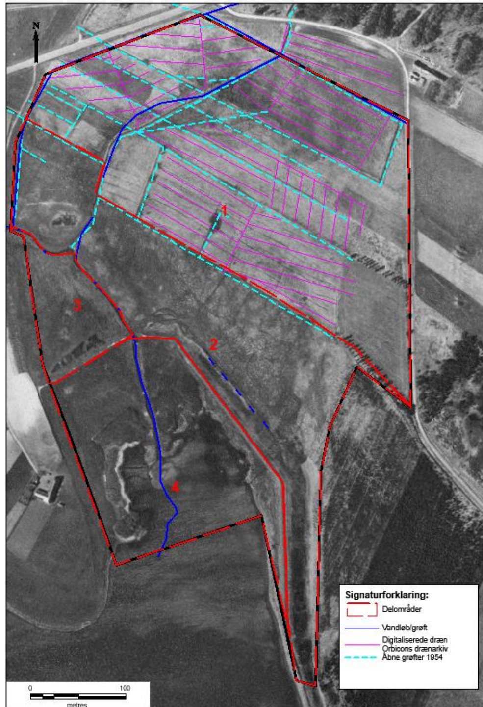
Figur 10 Digitaliserede dræn og grøfter på baggrund af flyfotos (1954) og drænkort fra Orbicons drænkortarkiv.
