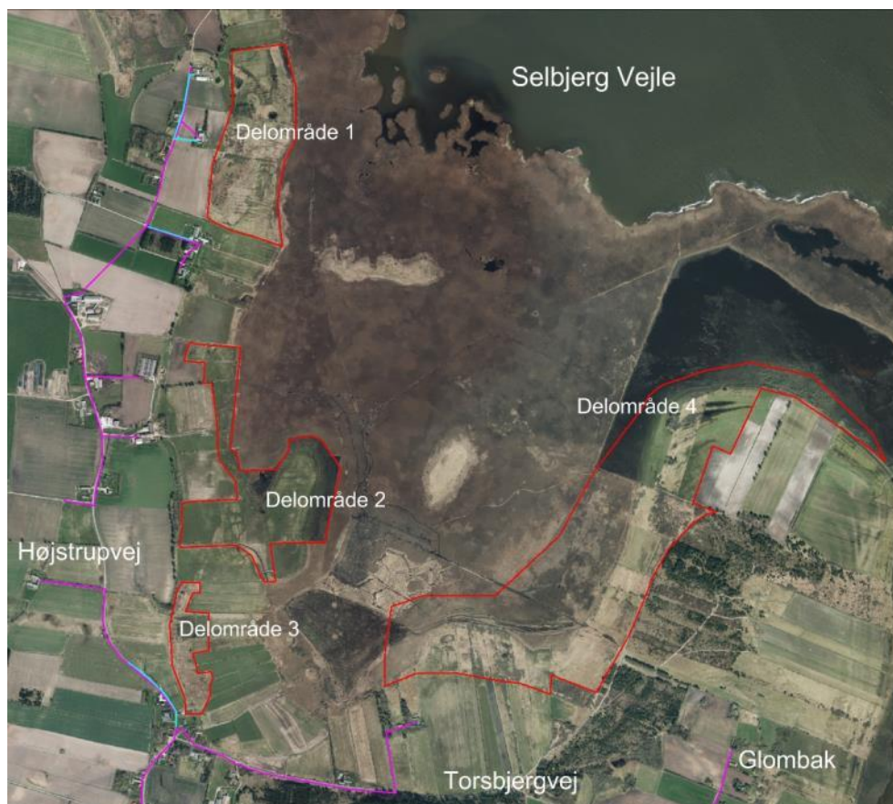
Figur 33: Oversigtlig fremstilling af oplyste ledningsanlæg i forbindelse med projektområdet: TDC-ledninger (lyseblå streg) og ledninger fra Thy-Mors Energi Service A/S (lilla streg).
