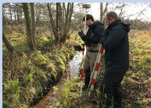
For at få overblik og indsigt i afledningsforholdene blev der gennemført opmålinger af vandløb, grøfter og det omgivende terræn.
