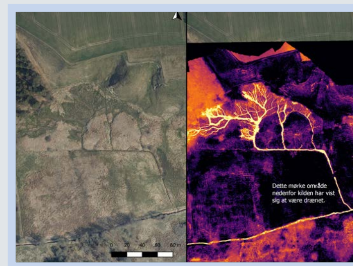
Figur 3: Eksempel på termobillede med kraftig forgrenet kildestrøm, som er kanaliseret og ført gennem drænet område til vandløbet ved Kastbjerg Å.
